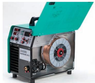
Как стандарт прецизионный 4-роликковый механизм подачи. Для 5 кг или 15 кг намоточных барабанов.
