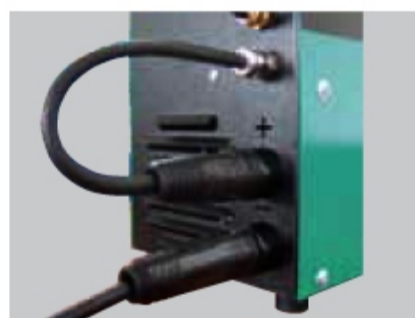
Быстрая смена полярности для сварки безгазовой проволокой
